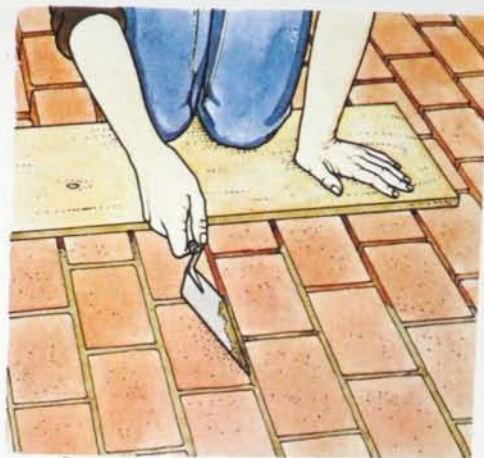
Si possono cementare i mattoni inserendo malta bagnata nelle fessure per mezzo di una cazzuola.
